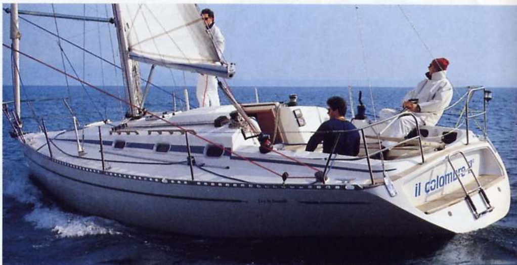
Il Fax è un dieci metri da crociera-regata progettato da Alain Jézéquel sui parametri di stazza IMS. Il baglio massimo arretrato e la contenuta lunghezza al galleggiamento definiscono una superficie bagnata piuttosto ridotta e quindi una particolare propensione ai venti medio-leggeri.
