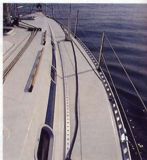
La lunga rotaia del genoa è addossata alla tuga e lascia liberi i passavanti. L'attrezzatura di coperta è Harken, gli stopper sono Spinlock.
