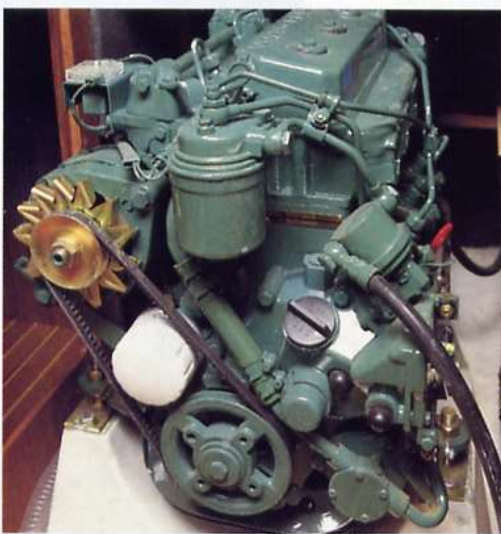
Il Volvo Penta da 18 cv è perfettamente accessibile togliendo il coperchio insonorizzato. Anche sul retro ci sono botole d'ispezione.
